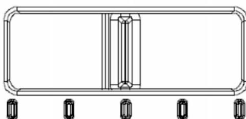
Для эксплуатации печи на минимальной мощности, установить регулятор подачи воздуха в полностью закрытом положении (Рисунок 5) и если у Вас установлена задвижка в дымоходе, также закрыть задвижку.
